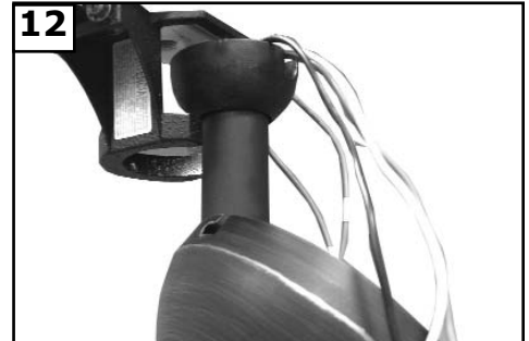
Accrochez le ventilateur assemblé du support installé sur le plafond dans l'étape précédente. Assurez-vous que le ventilateur accroche directement. Tournez le ventilateur jusqu'à ce que l'étiquette sur le support engage la fente sur la boule de Downrod. Ceci doit être fait pour empêcher le corps de ventilateur de tourner quand les lames sont dans le mouvement.
