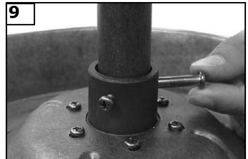
Insérez le downrod dans le joug sur le corps de ventilateur. Alignez le trou dans le downrod avec le trou dans le joug. Passez la goupille dans le joug et le downrod jusqu'à ce que le point apparaisse de l'autre côté.
