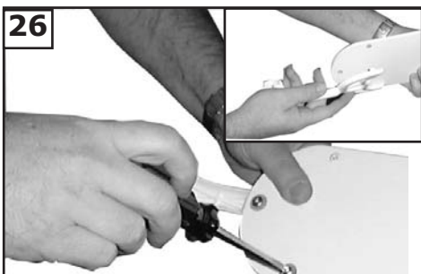
26 Placez les porte-pales sur les pales en alignant les trous de chaque porte-pale avec les trous de chaque pale. Assurez-vous que le côté de la pale que vous sélectionnez est tourné vers le bas. Installez 3 vis et les rondelles en fibres à l'arrière de la pale comme indiqué. Serrez les vis à fond. Répétez ce processus 4 fois jusqu'à ce que vous ayez assemblé toutes les pales.
