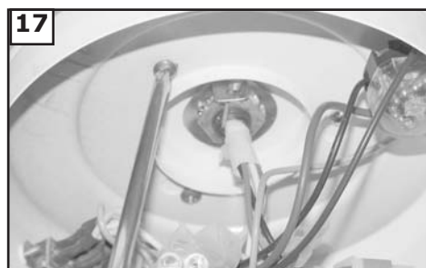
17 Installer la plaque du boîtier d'interrupteur en faisant tourner la plaque avec les trous piriformes jusqu'à ce qu'elle s'enclenche. Remettre en place la vis déposée et bien serrer les 3 vis.
